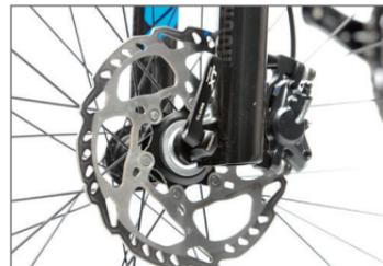
Ein Mehrschicht-Aufbau (ICE-Tech) kühlt die Bremsscheibe effektiv
